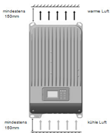
Abbildung 3.1: erforderliche Montage/Freiraum für Luft
